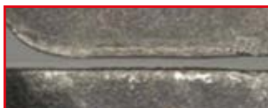
Tagliante meno soggetto a intaglio durante la lavorazione dell'acciaio inossidabile
